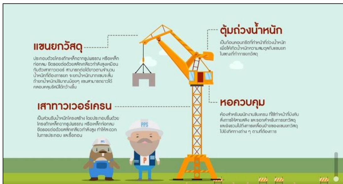
รูปที่ 2.13.3-3 ส่วนประกอบของทาวเวอร์ เครน (Tower crane) แบบบูมกระดก
